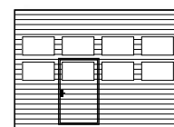
Plná ocelová vrata s prosklením a integrovanými personálními dveřmi
