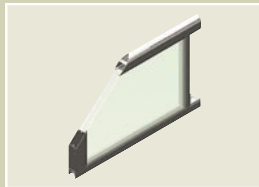
Sekce z hliníkových profilů s dvojitým akrylátovým sklem
